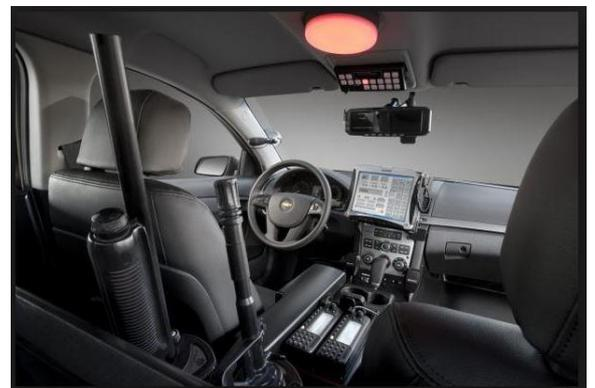
**LA MOVILIDAD vs PORTABILIDAD:** Con solo un peso de 2,2 Kg y la disposición de elementos de fijación quita y pon, el tablet Toughpad, alcanza un nuevo hito en la portabilidad de sistemas en vehículos policiales.
